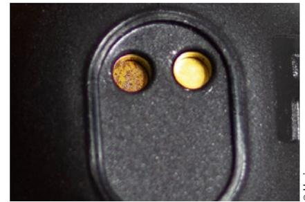
Kontakte eines Fitnessarmbandes nach dem Ladevorgang: Der linke Kontakt, zuvor mit Schweißblösung verunreinigt, zeigt eine deutliche Korrosion der Goldschicht im Vergleich zum rechten, nicht verunreinigten Kontakt.
